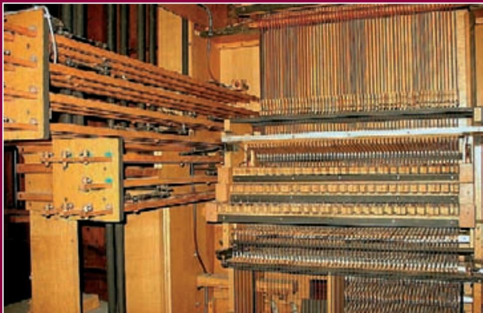
L'arrière de la console : vue de la mécanique (vergettes, tirants de registres)
